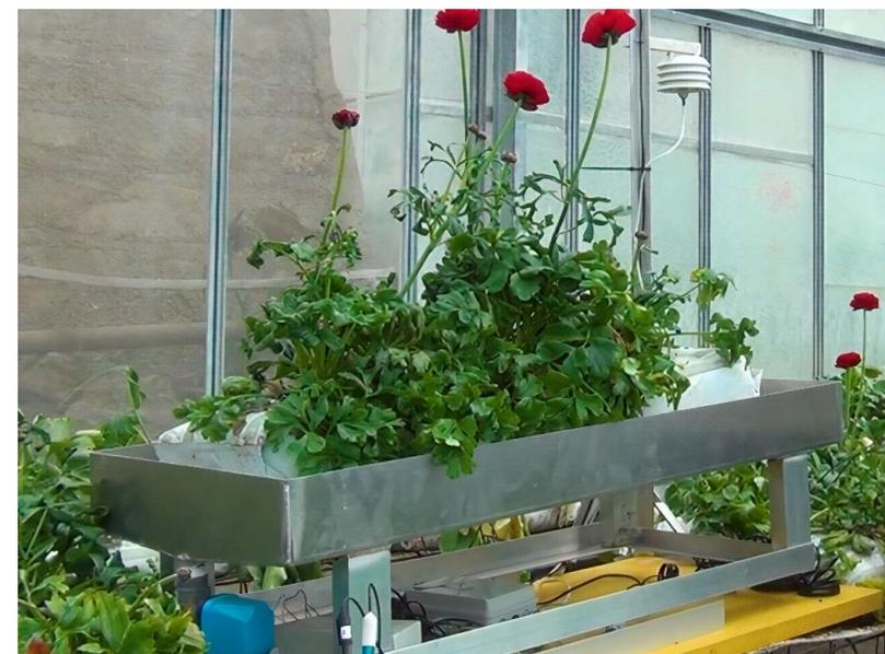
Inoltre, l'uso del lisimetro permette al coltivatore anche di mantenere a livello radicale delle condizioni ottimali, prevenendo stress da eccessi idrici o salini ed evitando così riduzioni nella quantità e qualità di fiori recisi e/o la riduzione delle condizioni che predispongono la pianta ad attacchi fungini.
